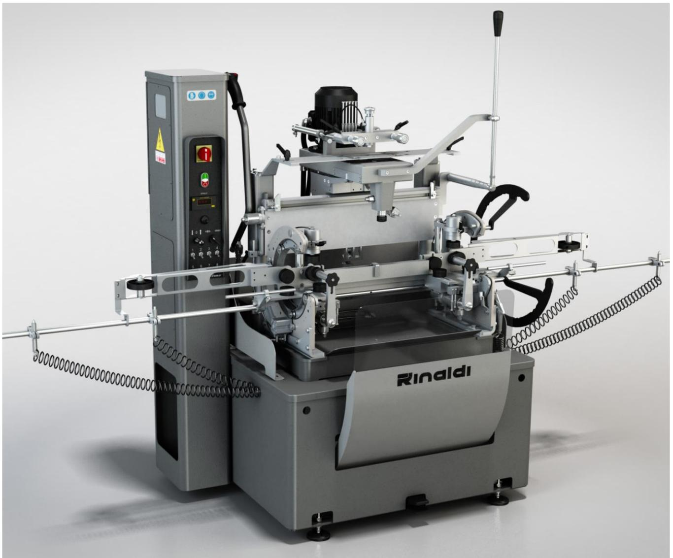
Pour **l'usinage sur 4 faces** par pivotement de 270° (sans desserrer le profilé) de tous profilés en alliages non ferreux, notamment en aluminium et de profilés acier (d'épaisseur maxi 3 mm).
